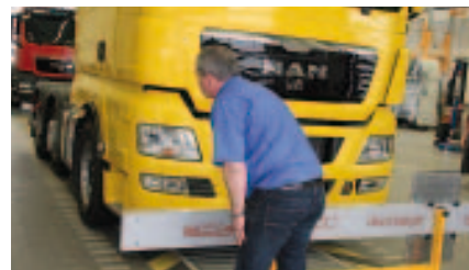
■ Anschließend wird die vordere Messtraverse mit Hilfe der Laserstrahlen exakt zur geometrischen Fahrachse des Fahrzeugs ausgerichtet.
