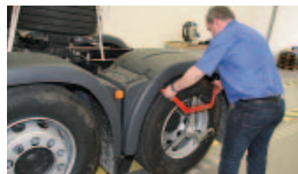
■ Zum Einstellen des ACC-Radarsensors werden die Lasermessköpfe des Justagesystems „LC-40 ACC-LKW“ mit den patentierten Haltern an der Hinterachse positioniert. (Fotos: Kuss)
