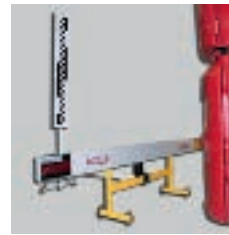
Mit dem Zusatztools „LC-40 ACC Sensorjustage“ lässt sich das „HD-30 Easy Touch“ von Koch auch zum Prüfen und Justieren von Kamerasystemen verwenden.
