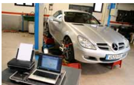
▲ El alineador Koch HD10 es un sistema fácil, sencillo y que no necesita ninguna instalación adicional en el taller que permite realizar la alineación de las ruedas del vehículo de forma tremendamente precisa. Dado que el sistema se basta con las leyes de la geometría y la precisión del láser, únicamente necesitaremos el ordenador para obtener los parámetros de alineación para el vehículo sobre el que trabajamos.
